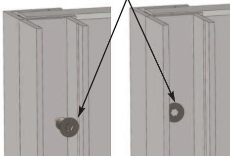
**TIPP:** Bohren Sie gegebenenfalls mit einem 2,5 mm Bohrer vor, bevor Sie die Profile verschrauben.
