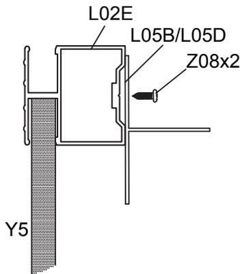
Stecken Sie das andere Ende jedes Y5 in den Kanal von jedem L02E. Befestigen Sie jeden L02E mit Z08 mit dem Akkuschrauber an jedem L05B & L05D.
