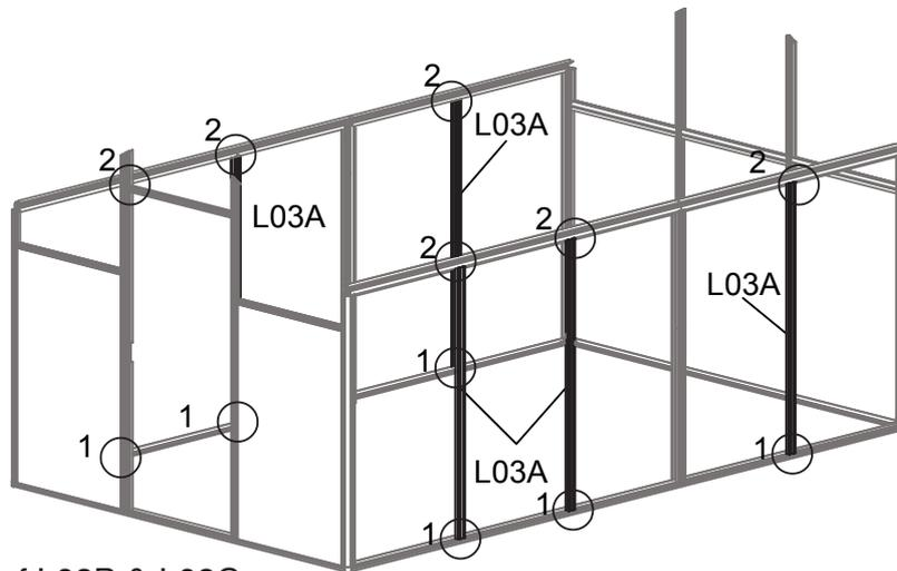
Montieren Sie jedes L03A auf L08B & L08C und L07B & L07C mittels S26.
