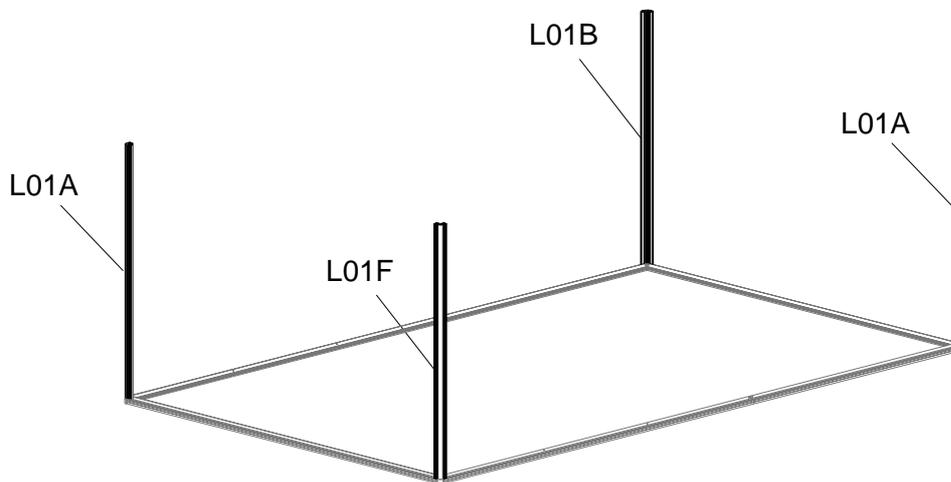
Montieren Sie L01A & L01B & L01F auf L08B & L08C und befestigen Sie sie mit S26.
