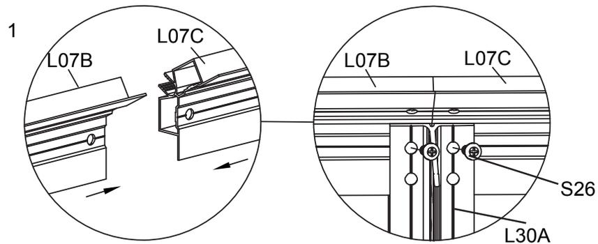
Montieren Sie L07B & L07C an L30A mittels S26.
