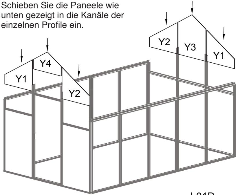
Montieren Sie L01C & L01D mit den zugehörigen Profilen wie unten gezeigt mit S26.
