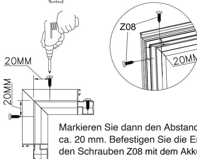
Markieren Sie dann den Abstand von beiden Enden ca. 20 mm. Befestigen Sie die Enden zum Schluss mit den Schrauben Z08 mit dem Akkuschauber.
