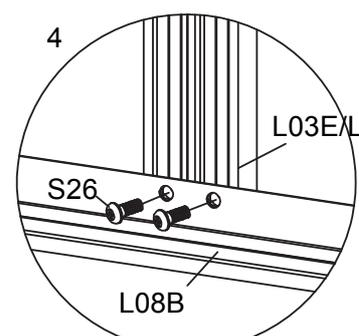
Montieren Sie ein Ende von L20A & L20B und L03E & L03F mit S26 auf L08B, wie in der Abbildung gezeigt.
