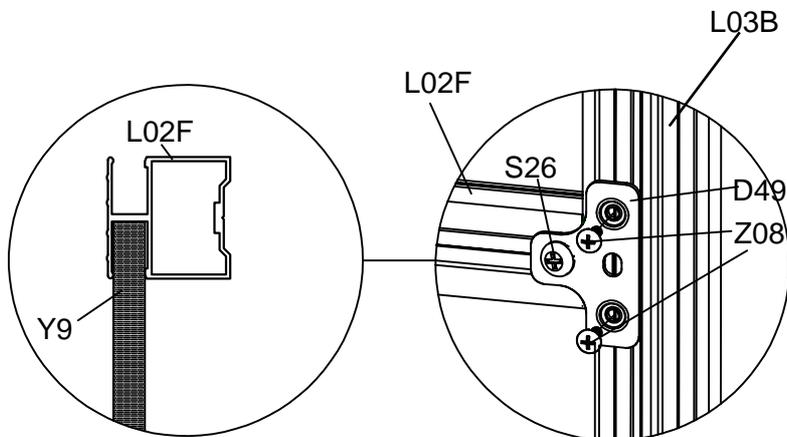
Stecken Sie das Ende von Y9 in den Kanal von jedem L02F. Verwenden Sie dann S26 und Z08, um die Halterung D49 mit dem Akkuschauber wie oben gezeigt an jedem L02F und L03B zu befestigen.
