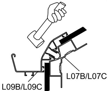
Montieren Sie die Dachrinnenprofile L09B und L09C. Sobald alle Paneele vollständig eingesetzt sind. Klopfen Sie dann vorsichtig mit einem Gummihammer L09B & L09C in den Kanal von L07B & L07C.
