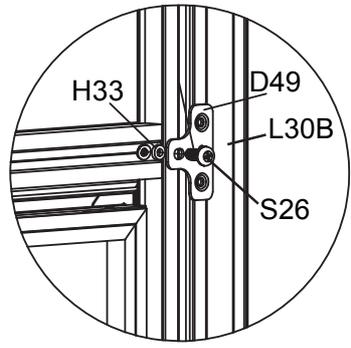
\* Stellen Sie sicher, dass der Abstandshalter H33 richtig platziert ist, bevor Sie D49 montieren, der nur für L30B benötigt wird.
