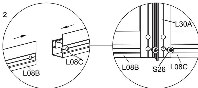
Montieren Sie L08B & L08C am anderen Ende von L30A mittels S26.
