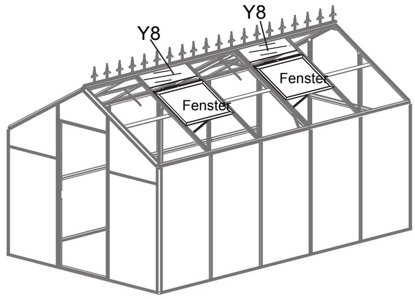
\* Vergewissern Sie sich, dass Y8 den Boden erreicht und kein Spalt ist, bevor Sie die Schrauben festziehen.
