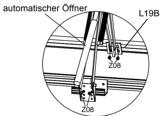
Verwenden Sie Z08, um D115 auf L02F zu sichern, und montieren Sie dann den automatischen Öffner mit Z08 auf D115 und L19B (Fensterprofil).
