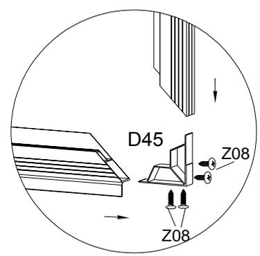
Stecken Sie D45 in die Enden der Profile L16 & L18A & L18B & L18C und dann markieren Sie den Abstand von jedem Ende ca. 20 / 30 mm.
