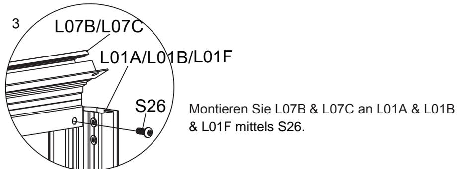
Montieren Sie L07B & L07C an L01A & L01B & L01F mittels S26.
