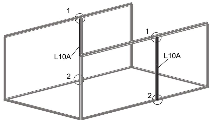
Montieren Sie jedes Ende von L10A über L30A mit S26 auf L07B & L07C und L08B & L08C.
