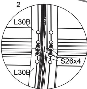
Montieren Sie L03B wie unten gezeigt mit S26 auf den Trauf- und Dachprofilen.
