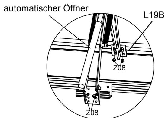
Verwenden Sie Z08, um D115 auf L02F zu sichern, und montieren Sie dann den automatischen Öffner mit Z08 auf D115 und L19B (Fensterprofil).
