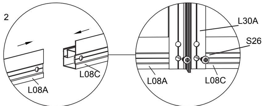
Montieren Sie L08A & L08C am anderen Ende von L30A mittels S26.
