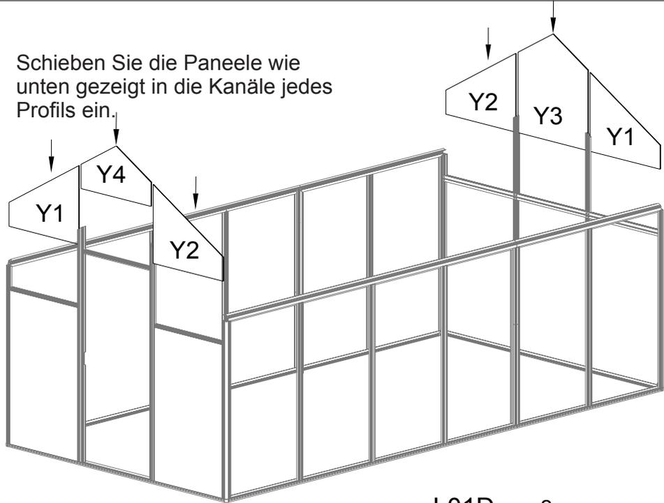
Montieren Sie L01C & L01D mit den zugehörigen Profilen wie unten gezeigt mit S26.
