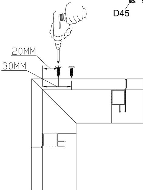
Stecken Sie D45 in die Enden der Profile L16 & L18A & L18B & L18C und dann markieren Sie den Abstand von jedem Ende ca. 20 / 30 mm. Zum Schluss mit den Schrauben Z08 verschrauben. \* Bitte stellen Sie sicher, dass zwischen den einzelne Profilen keine Lücken bestehen.
