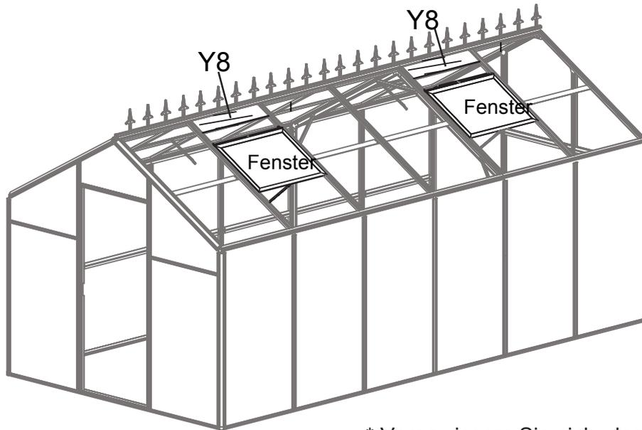
\* Vergewissern Sie sich, dass Y8 den Boden erreicht und kein Spalt ist, bevor Sie die Schrauben festziehen.
