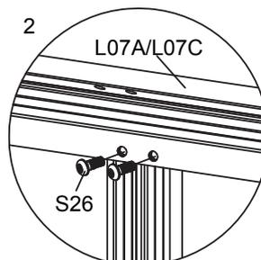
Montieren Sie jeden L03A mit S26 auf L08A & L08C und L07A & L07C.
