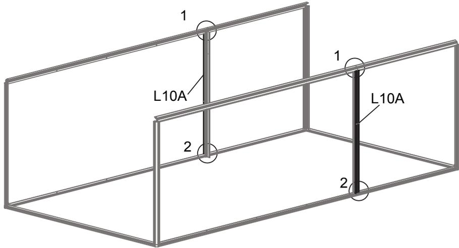
Montieren Sie jedes Ende von L10A mit S26 über L30A auf L07A & L07C und L08A & L08C.
