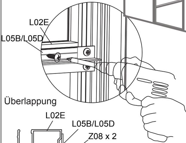
Schieben Sie das andere Ende jedes Y5 in den Kanal jedes L02E ein. Befestigen Sie jeden L02E mit Z08 mit dem Akkuschauber an jedem L05B & L05D.
