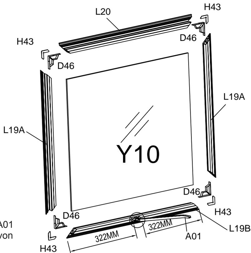
Montieren Sie den Fensterarm A01 in der Mitte von L19B, 322 mm von jedem Ende entfernt.
