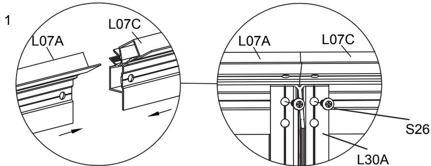
Montieren Sie L07A & L07C an L30A mittels S26.
