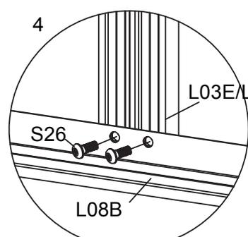
Montieren Sie ein Ende von L20A & L20B und L03E & L03F mit S26 wie gezeigt auf L08B. .
