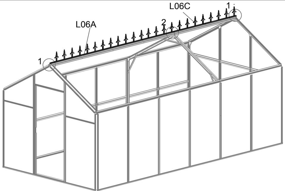
Montieren Sie L06A & L06C mit S26 auf L01C & L01D & L30B.
