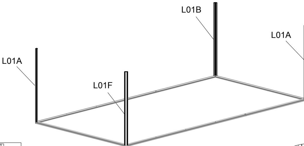
Montieren Sie L01A & L01B & L01F auf L08A & L08B & L08C und befestigen Sie sie mit S26.
