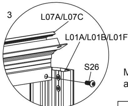
Montieren Sie L07A & L07C mit S26 auf L01A & L01B & L01F.
