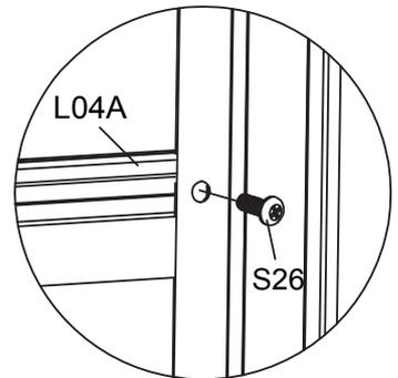
Montieren Sie L04A mit S26 auf L20A und L20B.
