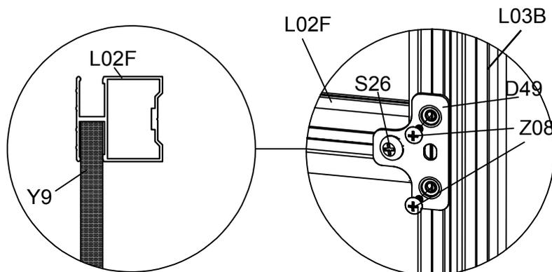
Stecken Sie ein anderes Ende von Y9 in den Kanal jedes L02F. Verwenden Sie dann S26 und Z08, um die Halterung D49 mit dem Akkuschauber wie oben gezeigt an jedem L02F und L03B zu befestigen.
