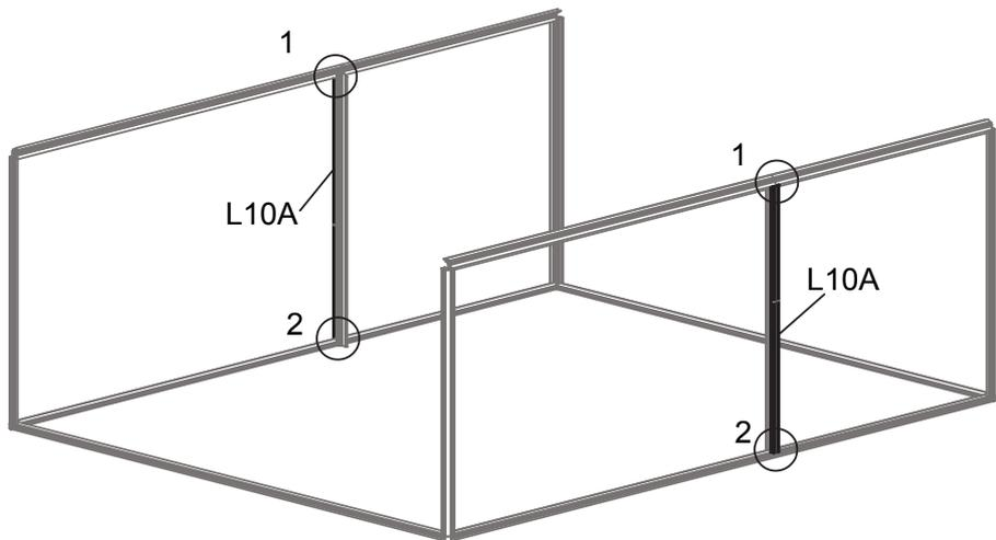
Montieren Sie jedes Ende von L10A mit S26 über L30A auf L07B & L07C und L08B & L08C.
