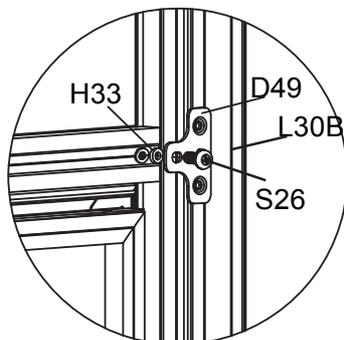
\* Stellen Sie sicher, dass der Abstandshalter H33 richtig platziert ist, bevor Sie D49 montieren. Nur für L30B benötigt.
