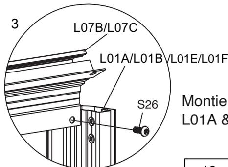
Montieren Sie L07B & L07C mit S26 auf L01A & L01B & L01E & L01F.
