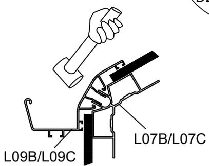
Montieren Sie die Dachrinnenprofile L09B und L09C. Klopfen Sie dann vorsichtig mit einem Gummihammer die Profile L09B & L09C in den Kanal von L07B & L07C.
