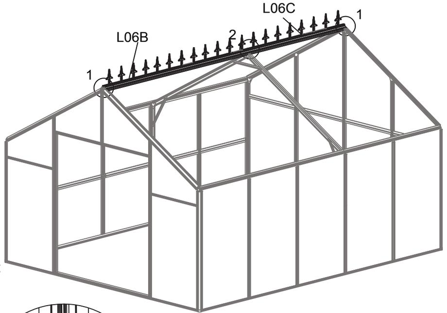
Montieren Sie L06B & L06C mit S26 auf L01C & L01D & L30B.
