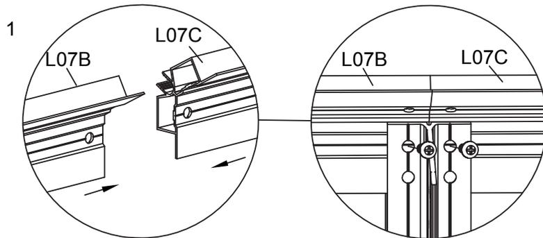
Montieren Sie L07B & L07C mit S26 auf L30A.
