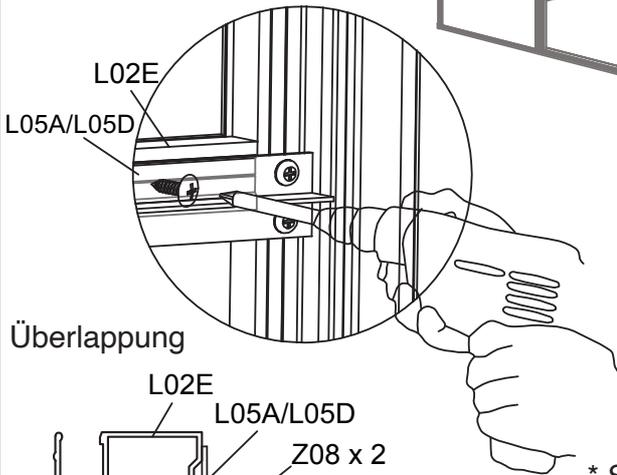
Führen Sie das andere Ende jedes Y5 in den Kanal jedes L02E ein. Montieren Sie jeden L02E mit jedem L05A & L05D mittels selbstschneidenden Schrauben Z08 mit dem Akkuschrauber
