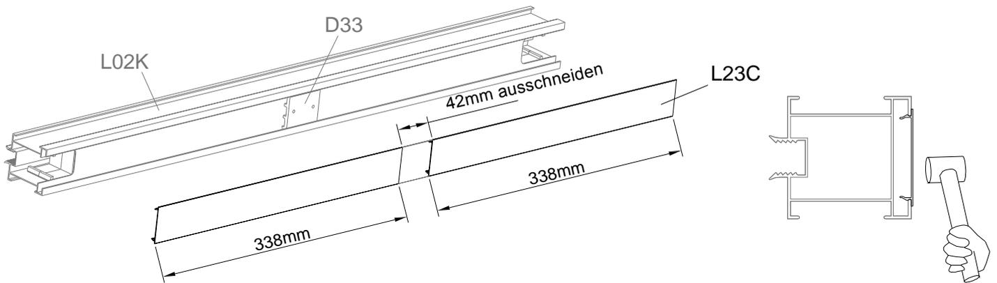
**HINWEIS:** Wenn der automatische Öffner montiert ist, schneiden Sie L23C in 2 Teile (Länge: 338MM/PC). Klopfen Sie sie vorsichtig mit einem Gummihammer in L02K und lassen Sie 42 mm Platz für D33.
