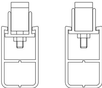
Montieren Sie 4 x L02B. Stecken Sie den Verbinder A38 in den Schlitz von L06 und L07, drehen Sie den Verbinder, bis er in das Loch von L02B einrastet. Ziehen Sie die Schraube im Verbinder A38 mit dem Schraubenschlüssel fest.
