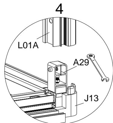
Montieren Sie L01A & C mit den Verbindern A29 & A30, stecken Sie Verbinder A29 & A30 in L01A & C ein, ziehen Sie die Schrauben mit dem Schraubenschlüssel fest, sobald sie in der richtigen Position sind.
