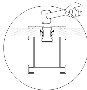
Bringen Sie die Platten und die Aluminiumleistenabdeckung in der oben gezeigten Reihenfolge an und klopfen Sie die Schienenabdeckung mit einem Gummihammer in die Kanäle.
