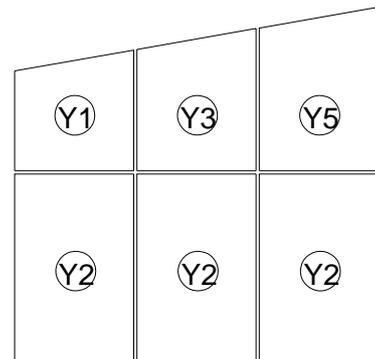
Bringen Sie die Platten und die Aluminiumleistenabdeckung in der oben gezeigten Reihenfolge an und klopfen Sie die Schienenabdeckung mit einem Gummihammer in die Kanäle.
