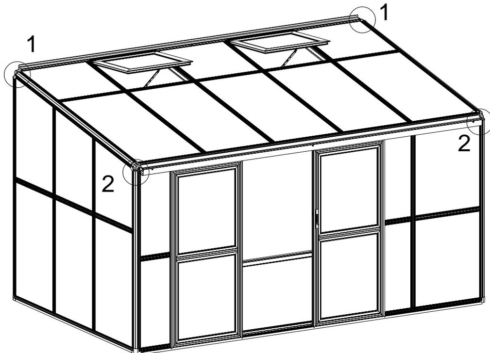
Montieren Sie die Abdeckbleche J15R/L und J14R/L mit den Schrauben Z02.
