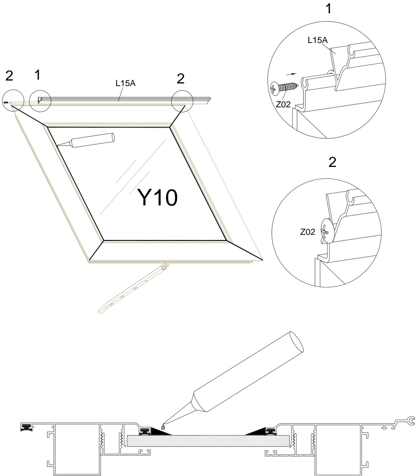
Füllen Sie die Lücken an den 4 Seiten mit Silikon, um Undichtheiten zu vermeiden. Stellen Sie sicher, dass ein für Polycarbonat geeignetes Silikon verwendet wird.
