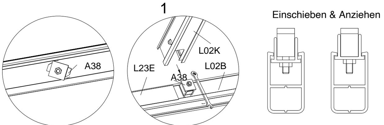
L02K montieren. Stecken Sie den Verbinder A38 in den Schlitz von L02B, drehen Sie den Verbinder, bis er in das Loch von L02K einrastet. Ziehen Sie dann die Schraube im Verbinder A38 mit dem Schraubenschlüssel fest. Stellen Sie sicher, dass der L02K fest mit L23E verbunden ist.
