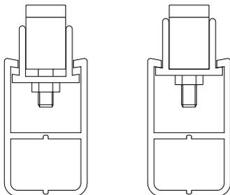
Stecken Sie den Verbinder A38 in den Schlitz von L01A & C und L02D & E & F & G, drehen Sie den Verbinder, bis sie in die Löcher von L02K einrasten. Ziehen Sie die Schrauben im Verbinder A38 mit dem Schraubenschlüssel fest.
