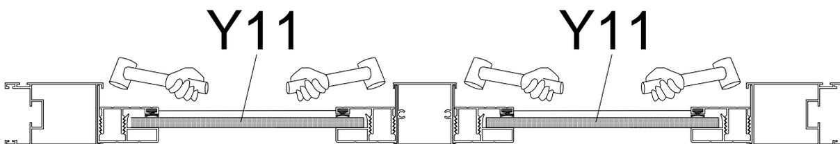
Die Glasscheibe Y11 muss rundherum mit der Aluminiumkappe L11H & J abgedeckt werden und dann mit einem Gummihammer vorsichtig auf die Profile geschlagen werden, bis Y11 fest verankert ist.
