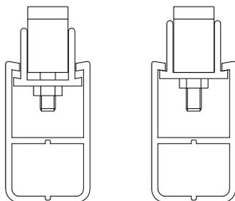
Montieren Sie 3 x L02A. Stecken Sie den Verbinder A38 in die Steckplatz von L07 und L10, drehen Sie den Verbinder, bis es passt in das Loch von L02A. Ziehen Sie die Schraube im Verbinder A38 mit dem Schraubenschlüssel fest.
