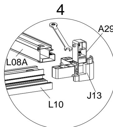
Montieren Sie L08A, L08B und L10 mit den Verbindern A29 und A30. Stecken Sie den Verbindern A29 & A30 in L08A & B und L10, ziehen Sie die Schrauben fest mit dem mitgelieferten Schraubenschlüssel, sobald sich die Stecker A29 & A30 in der richtigen Position befinden. Als nächstes muss J13 gleichzeitig montiert werden.
