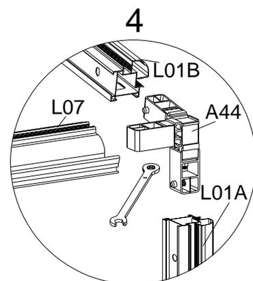
Montieren Sie L01B und L07 mit den Verbindern A44 und A45, stecken Sie die Verbinder A44 und A45 in L01B und L07 ein und ziehen Sie die Schrauben mit dem Schraubenschlüssel fest, sobald sie in der richtigen Position sind. Verbinden Sie sie dann mit L01A, indem Sie das andere Ende der Verbinder A44 und A45 verwenden, und ziehen Sie die Schrauben fest, sobald sie sich in der richtigen Position befinden.
