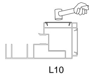
Klopfen Sie die Abdeckstreifen L23C & N in L10 und L07 vorsichtig mit einem Gummihammer fest. Stellen Sie sicher, dass zwischen jedem L23C und N in der Mitte 50 mm verbleiben, um die Montage des L02A in zukünftigen Schritten zu ermöglichen.
