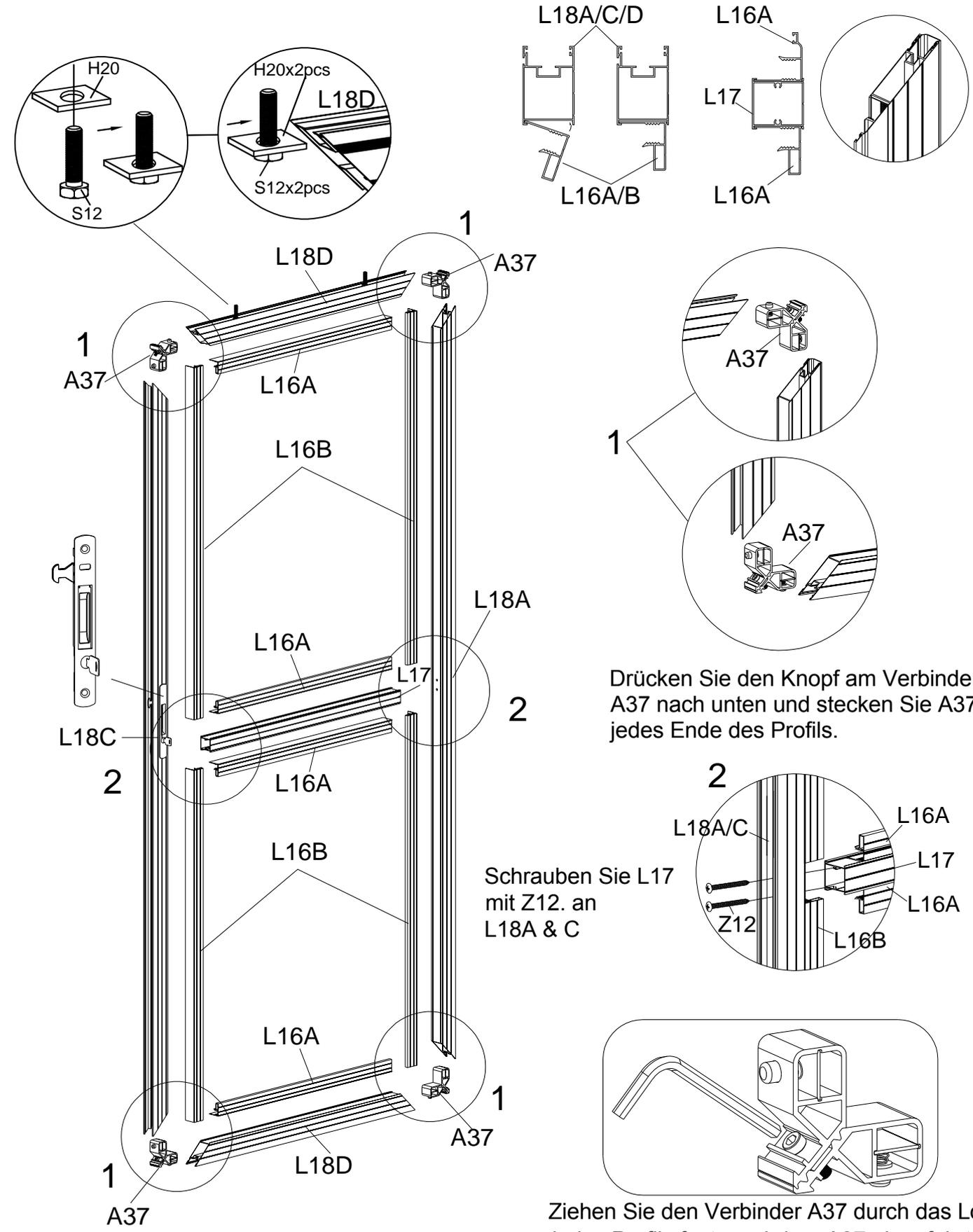
Drücken Sie den Knopf am Verbinder A37 nach unten und stecken Sie A37 in jedes Ende des Profils.
