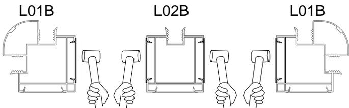
Klopfen Sie die Abdeckstreifen L23E & F in L01B und L02B vorsichtig mit einem Gummihammer fest. Stellen Sie sicher, dass zwischen jedem L23E und F, wie oben gezeigt, in der Mitte 50 mm verbleiben, damit die Montage von L02K in späteren Schritten funktioniert.
