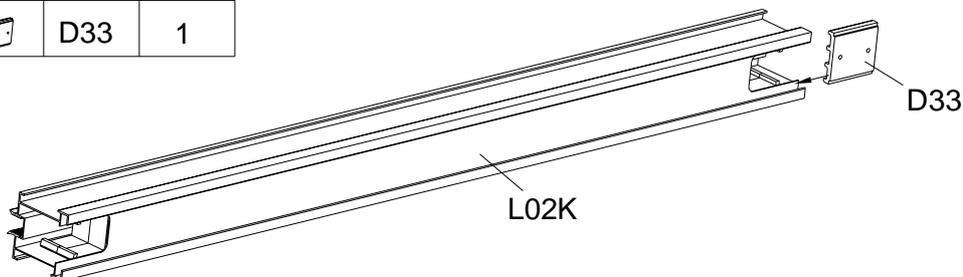
**HINWEIS:** Stellen Sie sicher, dass 1 x D33 in L02K eingeschoben ist, wenn der automatische Öffner montiert ist, bevor Sie L02K montieren (weitere Informationen finden Sie auf Seite 50).
