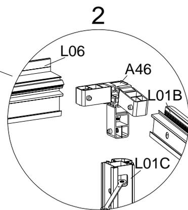
Montieren Sie L01B und L06 mit den Verbindern A46 & A47, stecken Sie die Verbinder A46 und A47 in L01B und L06 ein und ziehen Sie die Schrauben mit dem Schraubenschlüssel fest, sobald sie in der richtigen Position sind. Verbinden Sie sie dann mit dem anderen Ende der Verbinder A46 und A47 mit L01C und ziehen Sie die Schrauben fest, sobald sie sich in der richtigen Position befinden.
