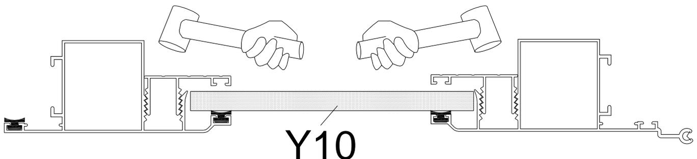
Die Glasscheibe Y10 muss mit der Aluminiumkappe L11F & G abgedeckt werden und dann mit einem Gummihammer vorsichtig auf die Profile geschlagen werden, bis Y10 fest im Profil befestigt ist.
