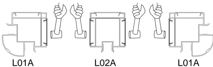
Klopfen Sie die Abdeckstreifen L23A & D in L01A und L02A vorsichtig mit einem Gummihammer fest. Stellen Sie sicher, dass zwischen jedem L23D in der Mitte 50 mm verbleiben, um die Montage von L02K in zukünftigen Schritten zu ermöglichen.
