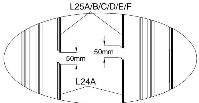
Schlagen Sie die Abdeckstreifen L24A und L25A & B & C & D & E & F wie oben gezeigt mit einem Gummihammer vorsichtig in die entsprechenden Aluminiumprofile. Stellen Sie sicher, dass zwischen L24A und L25A & B & C & D & E & F in der Mitte 50 mm verbleiben, um die Montage von L02K in zukünftigen Schritten zu ermöglichen. Machen Sie dasselbe auf den anderen Seiten.
