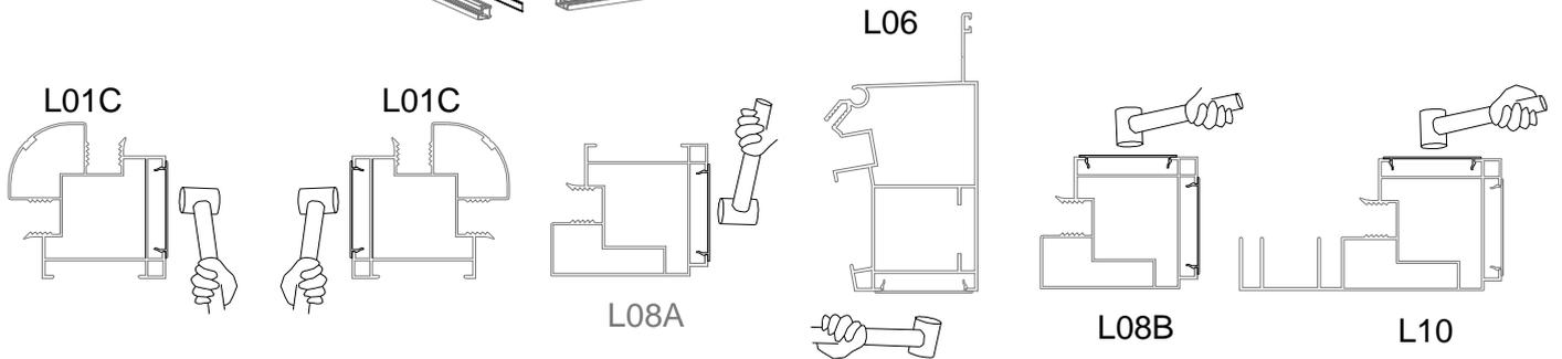
Klopfen Sie die Deckstreifen L26A in L01C, L26B in L08A und L26C in L06, L10 und L08B vorsichtig mit einem Gummihammer, wie oben gezeigt zusammen.
