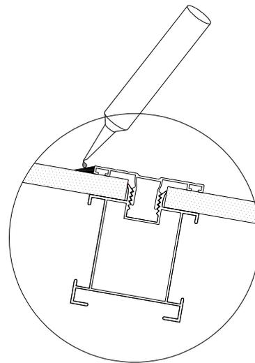
Verwenden Sie an den oben gezeigten Stellen Silikon um Undichtheiten zu vermeiden. HINWEIS: STELLEN SIE SICHER, DASS EIN FÜR POLYCARBONAT GEEIGNETES SILIKON VERWENDET WIRD.
