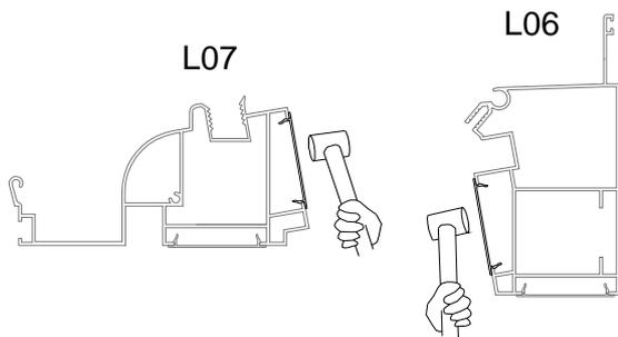
Klopfen Sie die Abdeckstreifen 10 x L23C in L06 und L07 vorsichtig mit einem Gummihammer fest. Stellen Sie sicher, dass zwischen jedem L23C in der Mitte 50 mm verbleiben, um die Montage von L02B in zukünftigen Schritten zu ermöglichen.
