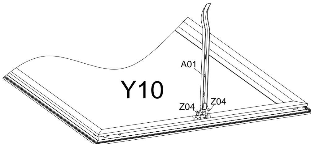
Verwenden Sie bei der Montage der manuellen Fensteröffner den A01 und befestigen Sie ihn mit den Z04-Schrauben. Bei der Montage von automatischen Öffnern können diese nach Fertigstellung des Gewächshauses eingebaut werden.
