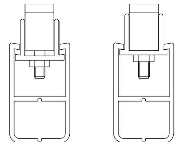
Stecken Sie Verbinder A38 in den Schlitz von L08A und A48 in den Schlitz von L01B, drehen Sie A38 & A48, bis sie in die Löcher von L02D & E & F & G einrasten. Ziehen Sie die Schrauben in den Verbindern A38 & A48 mit dem Schraubenschlüssel fest.
