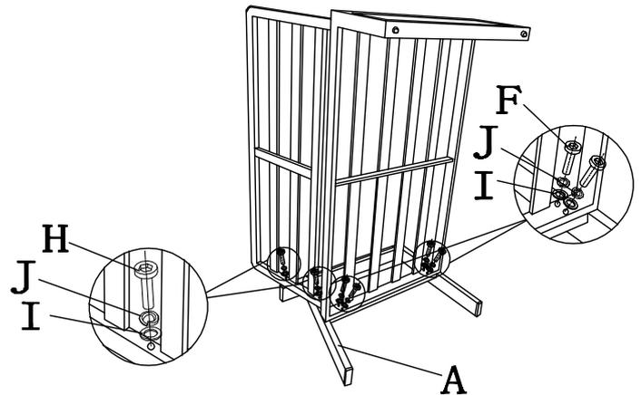
Bitte ziehen Sie die Schrauben nicht fest, bis alle Schrauben mit den Löchern ausgerichtet sind. Versuchen Sie zunächst, alle Schrauben locker anzuziehen, und ziehen Sie dann alle Schrauben ein wenig fester. Ziehen Sie nicht eine Schraube zu fest an, da dies das Anziehen der anderen Schrauben erschweren kann, sondern ziehen Sie am Ende alle Schrauben fest an.
