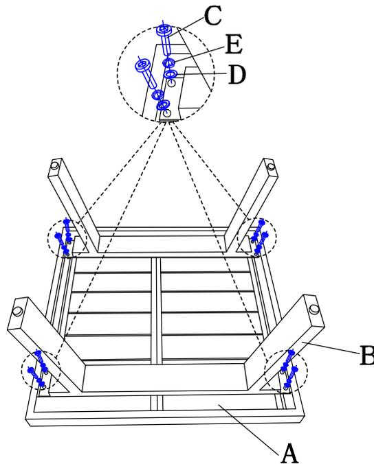
Bitte ziehen Sie die Schrauben nicht fest, bis alle Schrauben mit den Löchern ausgerichtet sind. Versuchen Sie zunächst, alle Schrauben locker anzuziehen, und ziehen Sie dann alle Schrauben ein wenig fester. Ziehen Sie nicht eine Schraube zu fest an, da dies das Anziehen der anderen Schrauben erschweren kann, sondern ziehen Sie am Ende alle Schrauben fest an.
