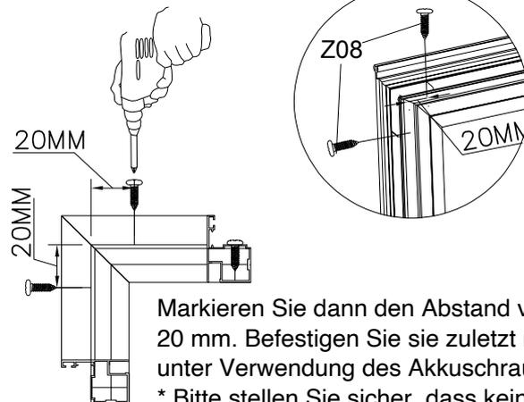
Markieren Sie dann den Abstand von jedem Ende etwa 20 mm. Befestigen Sie sie zuletzt mit den Schrauben Z08 unter Verwendung des Akkuschaubers.
