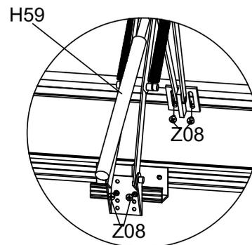
Verwenden Sie Z08, um D115 an L02F zu befestigen, und installieren Sie dann den automatischen Öffner H59 an D115 und L19B (Fensterprofil) mit Z08.
