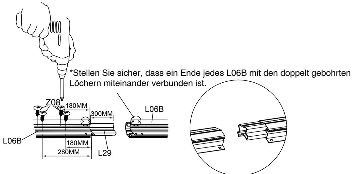
Setzen Sie die halbe Seite von L29 in eines der L06B ein, sodass 300 mm der Länge von L29 frei bleiben. Befestigen Sie L06B und L29 mit Z08 in den Abständen von 180 mm und 280 mm. Setzen Sie das andere Ende von L29 in das andere L06B ein und sichern Sie sie mit Z08. Stellen Sie schließlich sicher, dass die Verbindung ordnungsgemäß funktioniert.
