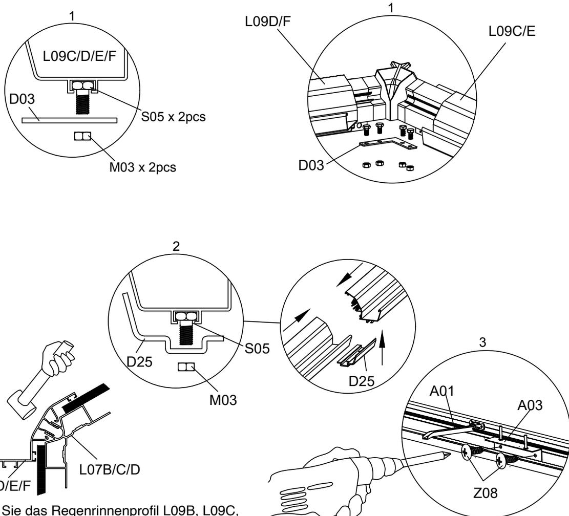
Installieren Sie das Regenrinnenprofil L09B, L09C, L09D, L09E und L09F, sobald alle Paneele vollständig eingesetzt sind. Klopfen Sie dann L09B, L09C, L09D, L09E und L09F vorsichtig mit einem Gummihammer in die Rillen von L07B, L07C und L07D.
