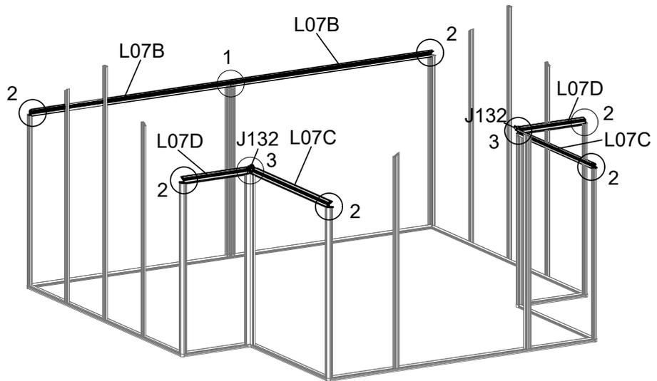
Installieren Sie jedes L07B, L07C und L07D mit der Schraube S26.
