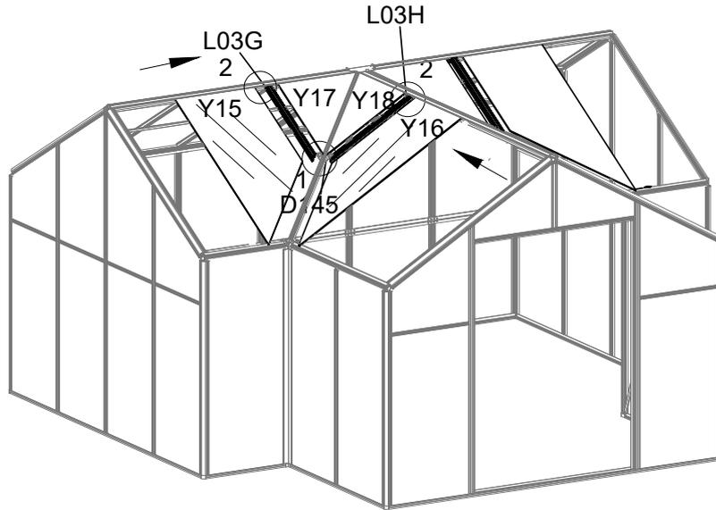
Installieren Sie L03G und L03H mit den entsprechenden Profilen und der Halterung D145 wie gezeigt unter Verwendung von S26.
