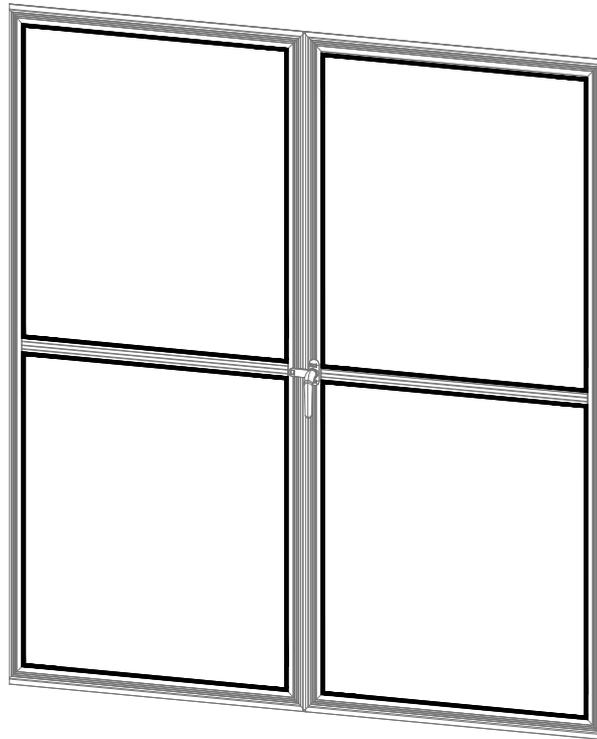
Setzen Sie den Gummi J107 zwischen die Verglasungspaneele und die Profile, wie unten gezeigt.
