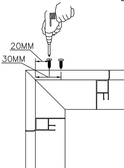
Setzen Sie den Verbinder D45 in jedes Ende der Profile L16A, L18A, L18B und L18C ein und markieren Sie dann den Abstand von jedem Ende etwa 20/30 mm. Befestigen Sie sie zuletzt mit den Schrauben Z08 unter Verwendung des Akkuschaubers.
