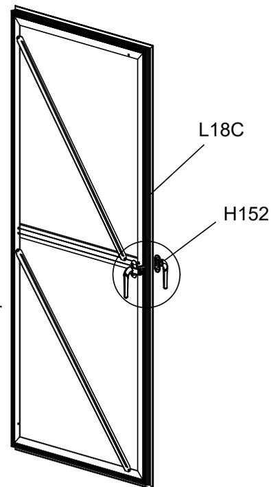
Sobald die Türen fertiggestellt sind, setzen Sie D47 in das Schlossloch ein, um H152 zu installieren. Achten Sie darauf, dass der Riegel von H152-1 zur Kante von L18C zeigt, und richten Sie die quadratischen Löcher von H152-1/2 mit D47 aus, bevor die endgültige Montage erfolgt. Befestigen Sie sie zuletzt mit S76 und setzen Sie die Kunststoffkappen auf.
