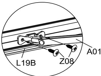
Setzen Sie die Halterung H43 und den Verbinder D46 in den Aluminium-Slot und das Rohr von L19A, L19B und L20 ein.
