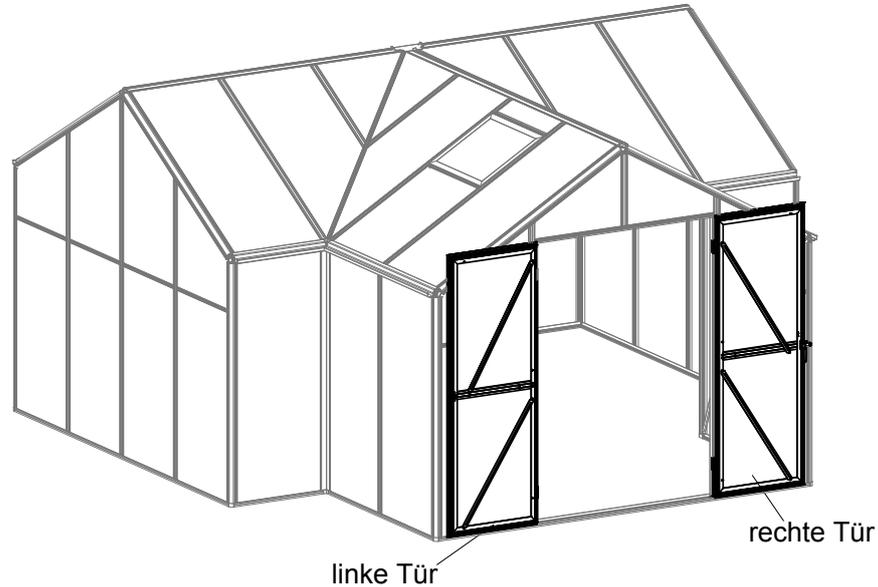
Verwenden Sie S27, um 4 Türscharniere A51 an jedes Türprofil L20A und L20B zu installieren, und befestigen Sie sie dann mit Z17, wie unten gezeigt.
