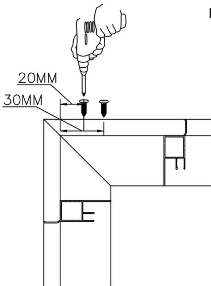
Setzen Sie den Verbinder D45 in jedes Ende der Profile L16B, L18A, L18B und L18D ein und markieren Sie dann den Abstand von jedem Ende etwa 20/30 mm. Befestigen Sie sie zuletzt mit den Schrauben Z08 unter Verwendung des Akkuschaubers.
