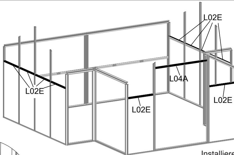
Installieren Sie L04A auf L20A und L20B mit S26.
