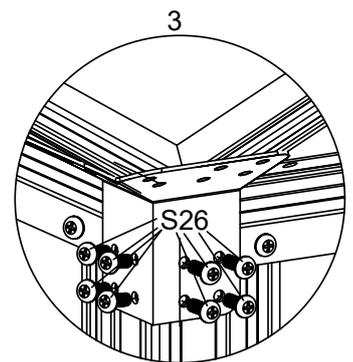
Installieren Sie L27B und L28A mit den entsprechenden Profilen und der Halterung wie gezeigt unter Verwendung von S05, S26 und Z08.
