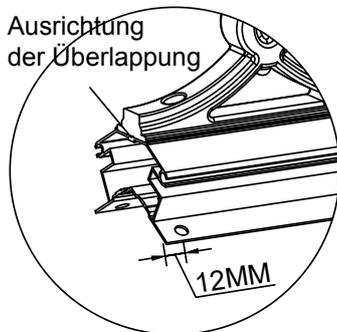
\*HINWEIS: Stellen Sie sicher, dass jedes J148 12 mm von jedem Ende von L06B und L06D entfernt platziert und befestigt wird.\*
