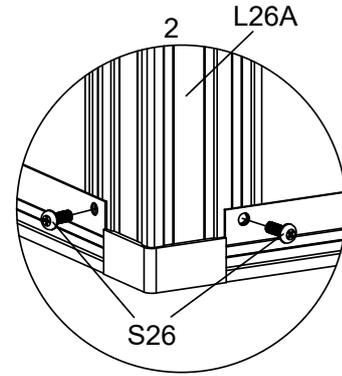
\*Stellen Sie sicher, dass der Winkel korrekt ist (90°), bevor Sie alle Profile festziehen.\*
