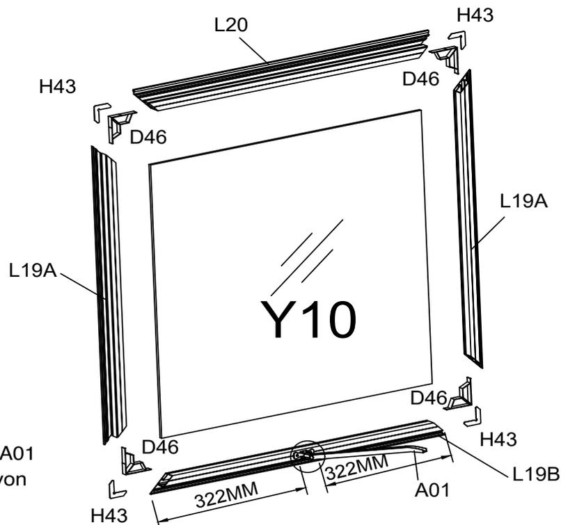
Installieren Sie den Fensterarm A01 in der Mitte von L19B, 322 mm von jedem Ende entfernt.
