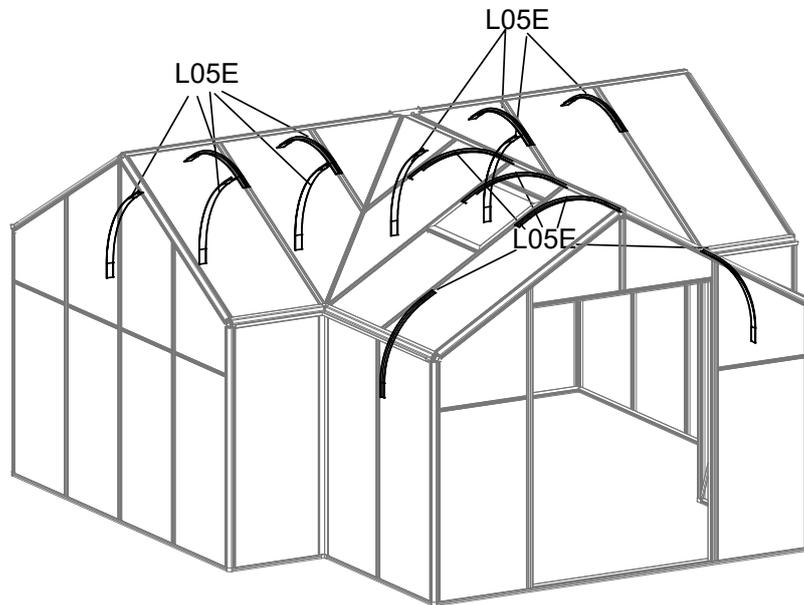
Verwenden Sie Z08, um jede Traufenstütze L05E zu befestigen.
