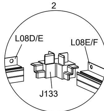
Setzen Sie J38 und J133 in jedes L08A, L08B, L08C, L08D, L08E und L08F ein.
