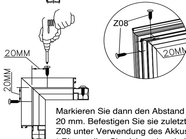
Markieren Sie dann den Abstand von jedem Ende etwa 20 mm. Befestigen Sie sie zuletzt mit den Schrauben Z08 unter Verwendung des Akkuschaubers.
