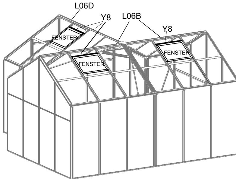
Setzen Sie zunächst Y8 in die Rille der entsprechenden Profile ein und schieben Sie es in die Rille von L06B und L06D. Setzen Sie dann L11 auf das andere Ende von Y8.
