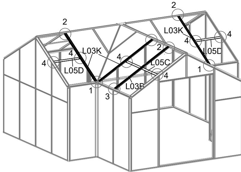
Installieren Sie L03B, L03K und L05B, L05C, L05D mit den entsprechenden Profilen unter Verwendung von S26.
