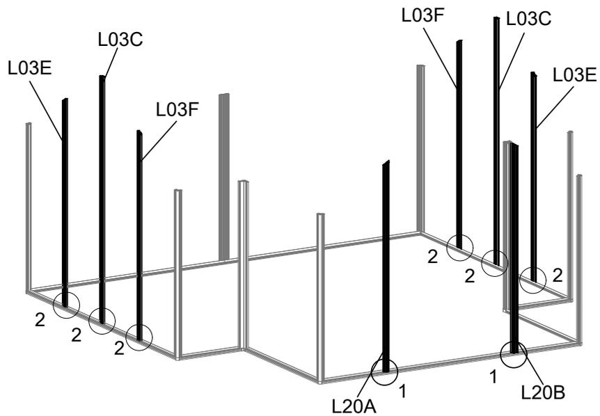
Installieren Sie alle Profile wie gezeigt auf L08A mit der Schraube S26.
