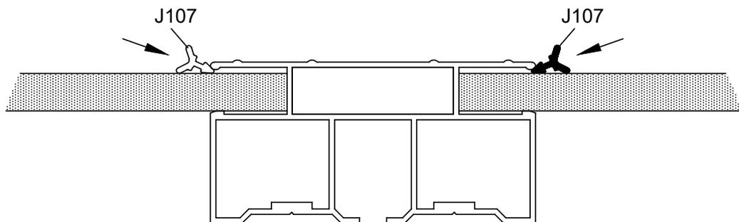
Setzen Sie den Gummi J107 zwischen die Verglasungspaneele und die Profile, wie unten gezeigt. Verwenden Sie Silikon, um ein Auslaufen zu vermeiden, sobald J107 eingesetzt ist.
