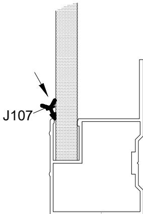
Setzen Sie den Gummi J107 zwischen die Glaspaneele und die Profile, wie unten gezeigt.
