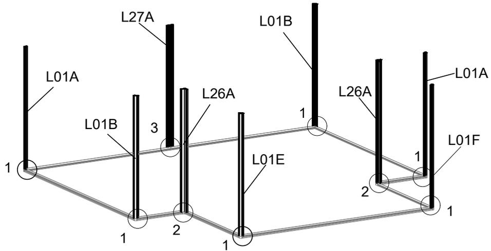
Installieren Sie alle Profile wie gezeigt auf L08A, L08B, L08C, L08D, L08E und L08F durch die J38 und J133 unter Verwendung der Schraube S26.
