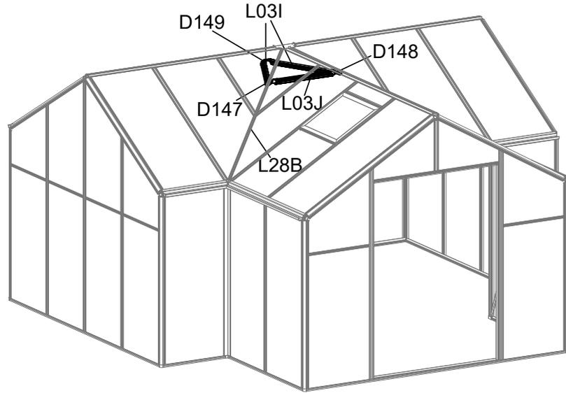
Setzen Sie D147, D148 und D149 in die vorgesehenen Positionen, um jedes L03I und L03J mit S26 zu installieren.
