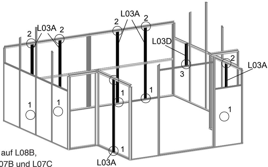
Installieren Sie jedes L03A auf L08B, L08C, L08D, L08F sowie L07B und L07C mit S26.
