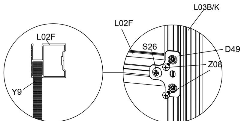
Setzen Sie das andere Ende von Y9 in die Rille jedes L02F ein und verwenden Sie dann S26 und Z08, um die Halterung D49 mit dem Akkuschauber an jedem L03B und L03K zu befestigen, wie oben gezeigt.
