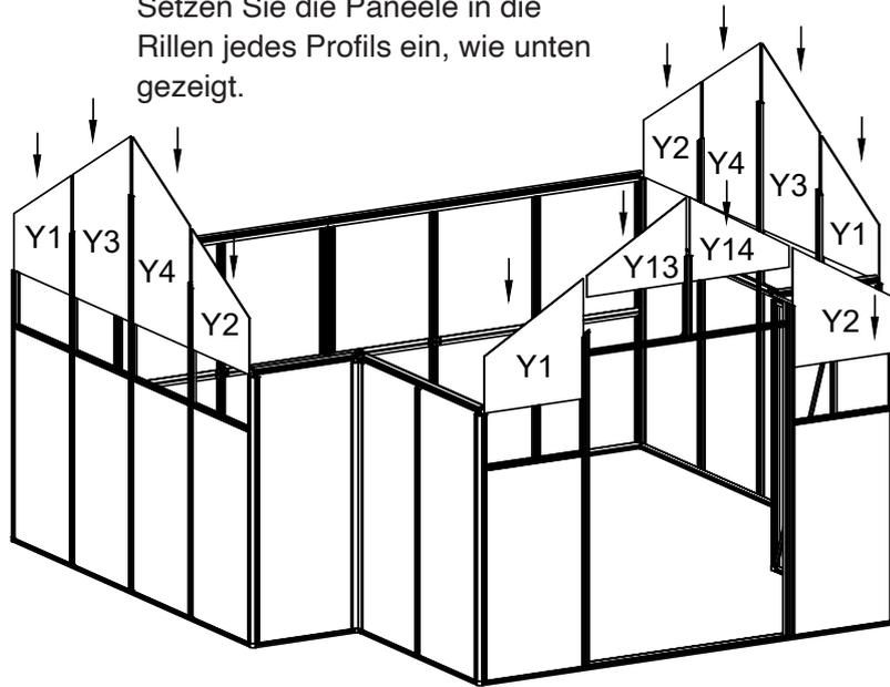
Installieren Sie L01C und L01D mit den entsprechenden Profilen wie unten gezeigt unter Verwendung von S26.
