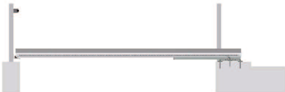
Fundament durchgehend, Durchfahrtbreite abgesetzt (z.B. für Pflasterung)
