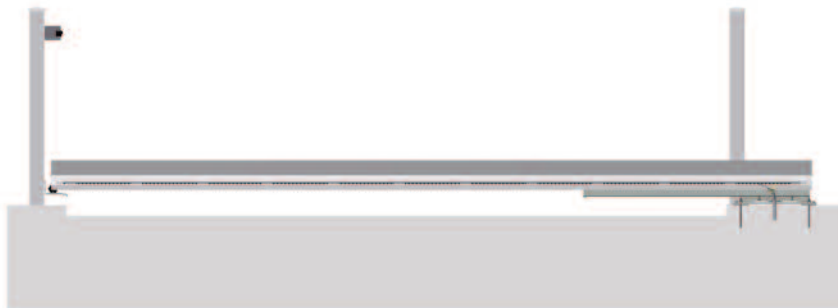
Fundament durchgehend, Durchfahrtbreite abgesetzt (z.B. für Pflasterung)
